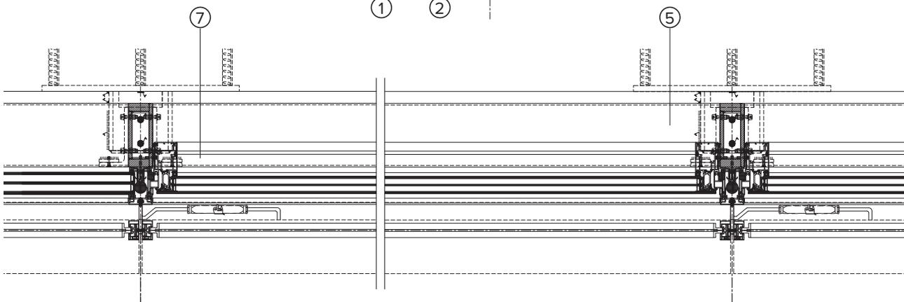
280 éléments en aluminium composent la façade principale, chacun de 2,80 x 3,75 m, constitué de deux vitrages fixes et de deux clapets de ventilation complétés par une tôle perforée servant de protection anti-chute. Ces dernières, déclinées en quatre nuances de vert, sont agencées de manière à éviter la juxtaposition de teintes similaires établissant ainsi une continuité visuelle harmonieuse avec le parc boisé au Sud.
